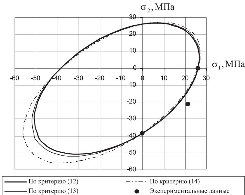
Рис. 4. Предельные линии в плоскости главных напряжений для эпоксидного компаунда
