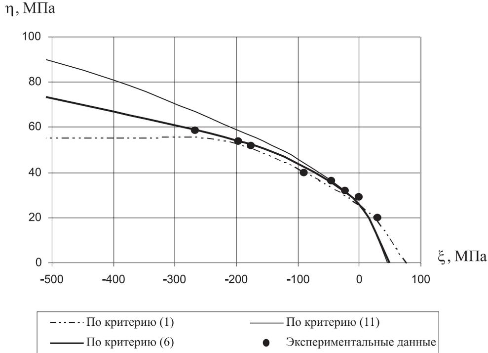
Рис. 2. Предельные кривые в плоскости  $\eta$  и  $\xi$  для эпоксидного компаунда
