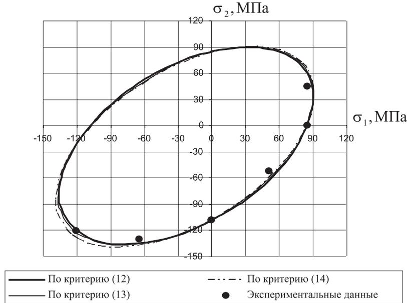
Рис. 3. Пределные линии в плоскости главных напряжений для ПММА
