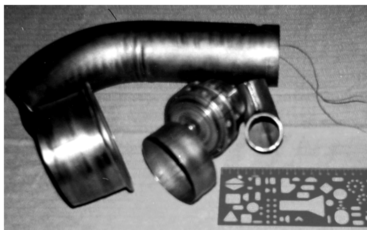
Рис. 4. Трубчатые детали, изготовленные с помощью центраторов с силоприводом из сплава с памятью формы
