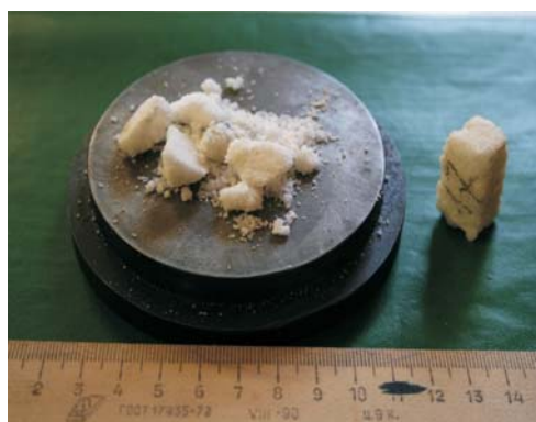
Рис. 3. Типичный характер разрушения образца аммиачной селитры
