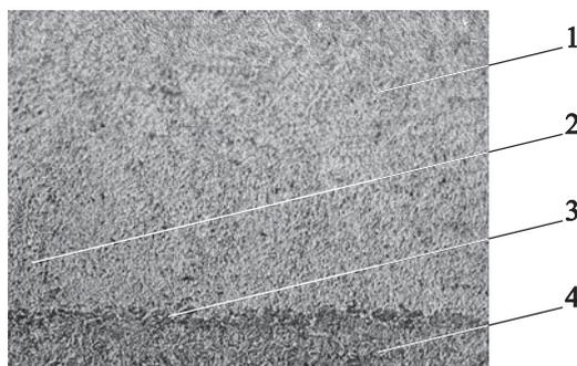
Рис. 2. Структура области лазерного воздействия после термоупрочнения хромоникельмолибденовой стали 40XНМА (увелич.  $\times 300$ ). 1 — закаленная зернистая структура мартенситного типа; 2 — область неполной закалки; 3 — переходная зона; 4 — исходная структура
