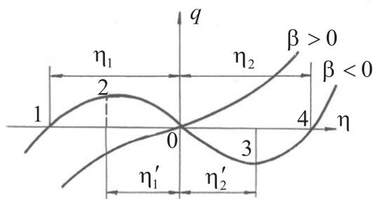
Рис. 2. Влияние знака управляющего параметра  $\beta$  на характер кривых  $q - \eta$
