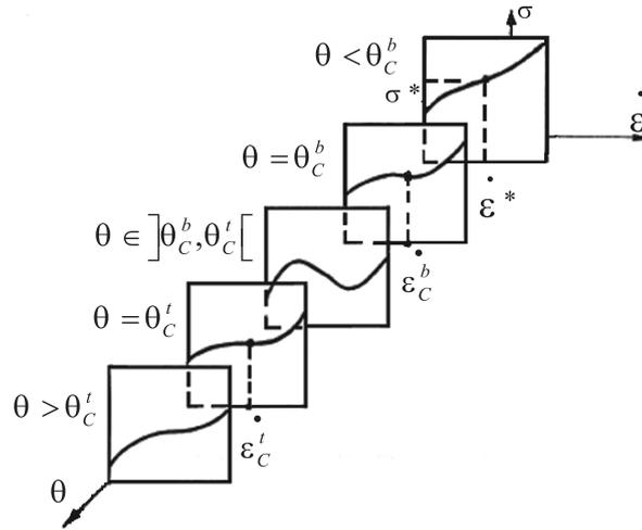
Рис. 1. Качественное представление экспериментальных зависимостей "напряжение – скорость деформации" в различных температурных диапазонах
