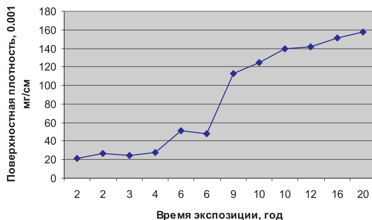
Рис. 2. Зависимость средней поверхностной плотности загрязнения фарфоровой детали трансформаторов выбросами тепловозов от времени экспозиции
