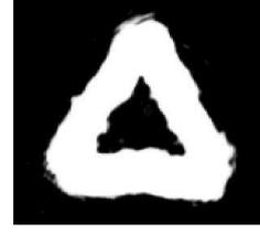
**Рис. 23.** Экспериментальное распределение интенсивности спирального пучка в форме треугольника (+1 порядок дифракции)
